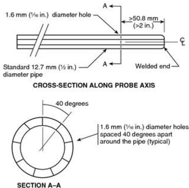
**FIGURE 4.4.1(b) Pressure-Sensing Probe.**
