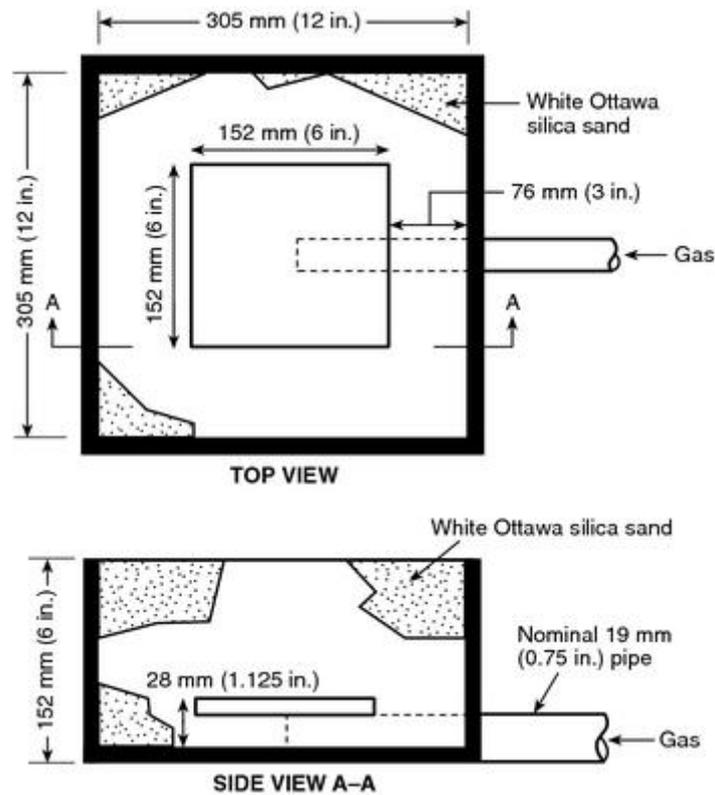
**FIGURE 4.1.1 Gas Burner.**
