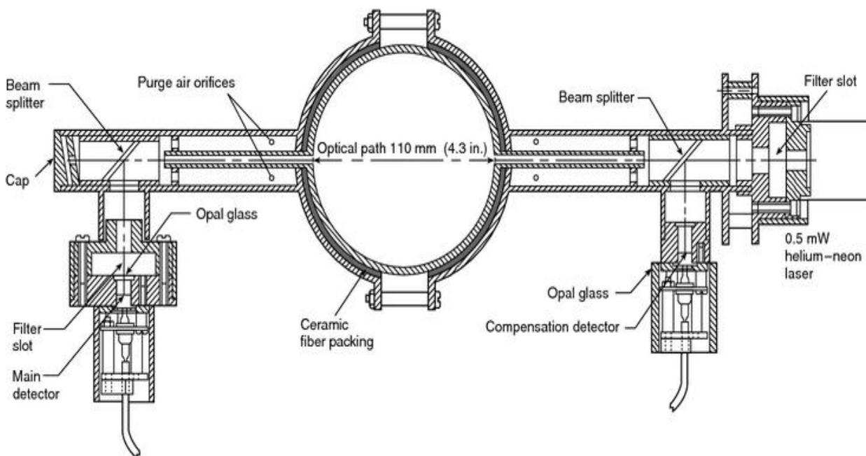
**FIGURE 7.3.8.3.2(a) Laser Extinction Beam.**
