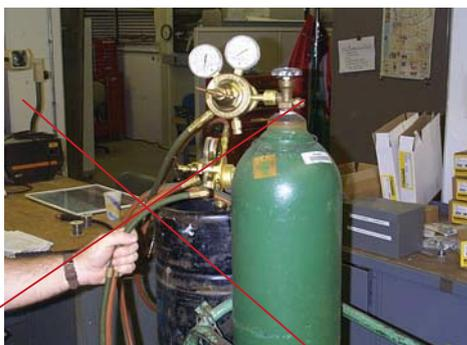
ابتدا باید شیلنگ رابط بین تورچ و سیلندرها به تورچ و سپس به سیلندرها متصل شود.
