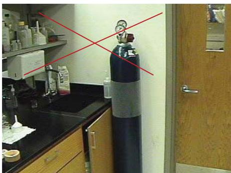
وقتی که از سیلندر استفاده نمی شود باید رگلاتورهای آن برداشته شود و سرپوش بر روی شیر آن قرار گیرد.
